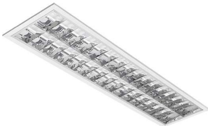
Figura 19 – Luminária tipo calha de embutir para lâmpadas T8, corpo em chapa de aço pintada na cor branca microtexturizada, aletas parabólicas alto brilho. (EAA05-E)
